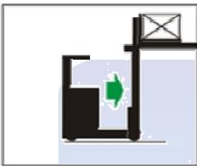
Avançar a torre lentamente atento para a entrada dos garfos no palete. Corrigir lentamente o necessário da operação. Elevar os garfos alguns centímetros. Se houver espaço entre a carga e a estante acima do palete, inclinar os garfos para trás utilizando a alavanca dedicada no comando.
