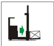
Para depositar o palete no chão, avance totalmente a torre de elevação, incline os garfos para a posição horizontal e desça lentamente evitando choque contra o piso. Recue a torre de elevação totalmente tentando não arrastar os garfos no piso.
